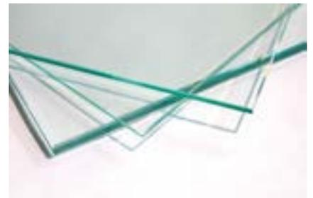
**Templado:** Es un tipo de vidrio de seguridad, que cuenta con tratamientos térmicos para aumentar su resistencia mecánica y térmica. Siendo mucho más resistente a los golpes y al choque térmico.
