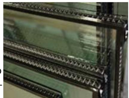
Aberturas Pampeanas S.A. utiliza el sistema Truseal para la fabricación de sus DVH.
